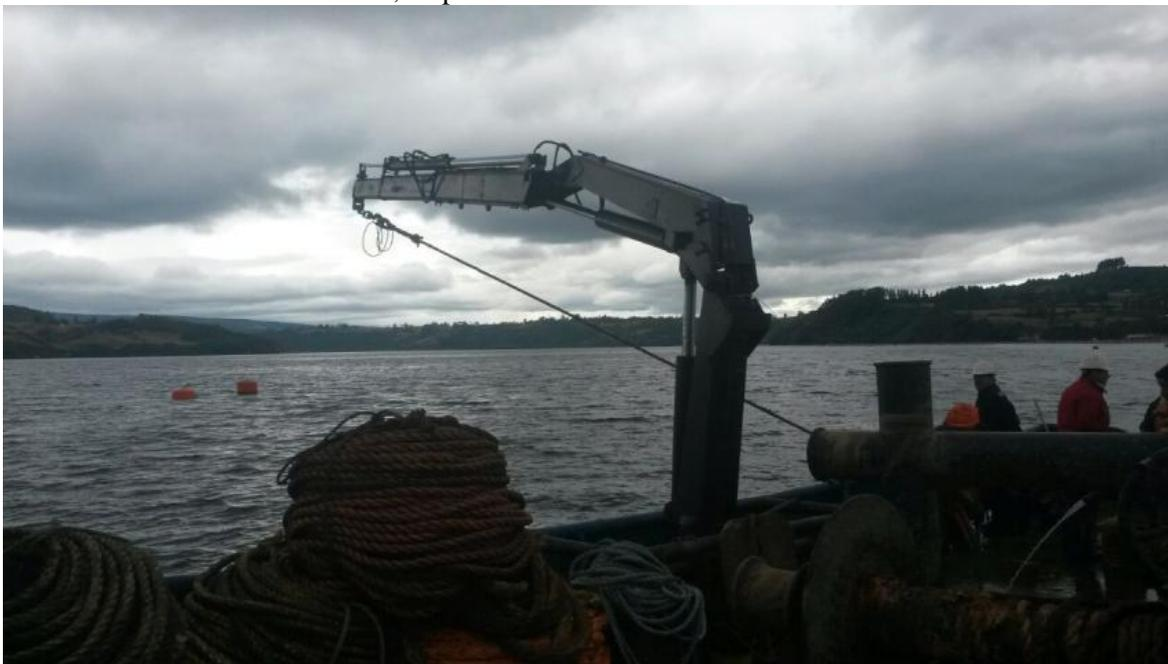
**Cabezal de Virado Rápido:** Capacidad de levante 2 Toneladas
